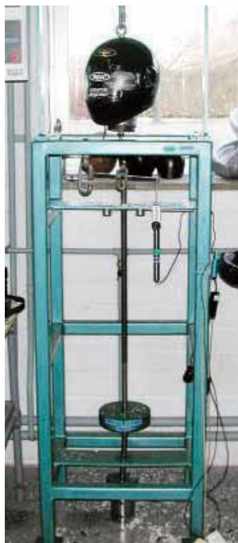
Uit de trektest kan worden afgeleid wat er met de helm gebeurt op het ogenblik van de impact.
